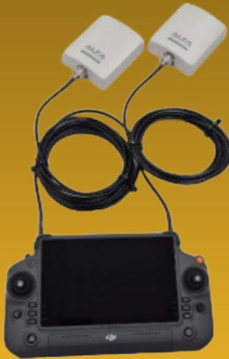
Kompakte Richtantennen ermöglichen eine deutlich erhöhte Reichweite und stabilere Verbindung zur Drohne. So kann der Pilot z.B. auch aus dem ELW heraus die Drohne steuern.
